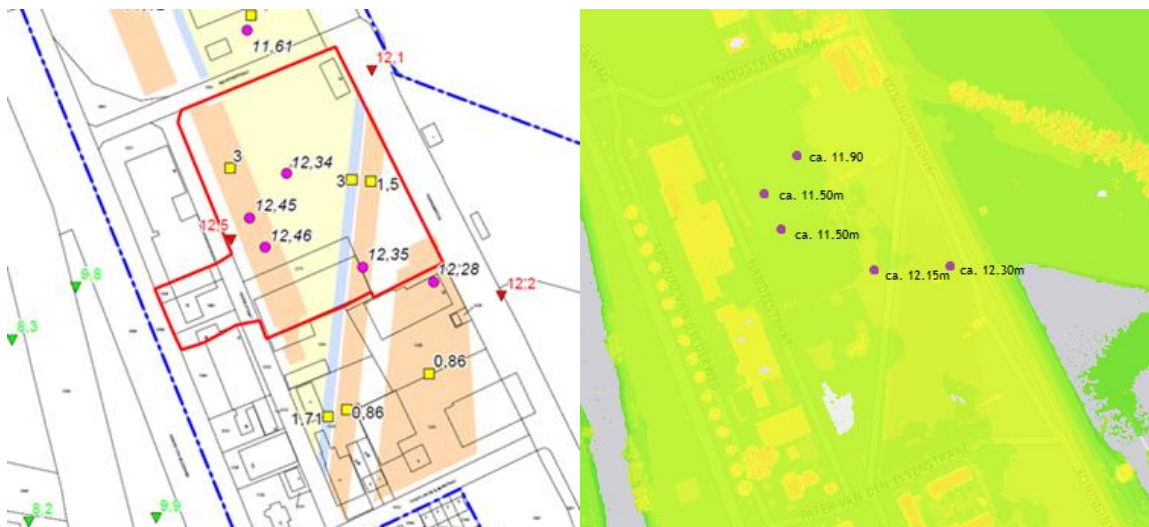
Afbeelding 6 en 7: Links de geïnterpoleerde hoogtes in paars (rood en groen zijn Heidemij 1956 en RWS 1967) 3 ; rechts dezelfde punten (bij benadering) volgens het AHN 4
